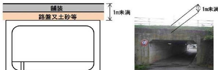
図 13 溝橋(ボックスカルバート)の考え方
