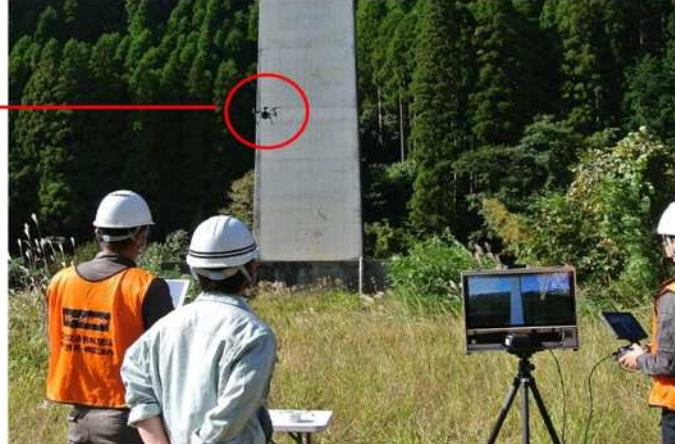
剥離・鉄筋露出や腐食等の形状・色調となるテストピースを現地の橋梁に設置し、使用する機器にて計測した外形寸法の数値精度を検証
